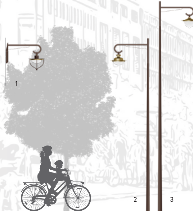
1 - Wall mounting S800 + Medicis VLC+uprights • 2 - Fontainebleau S800 + Charlemagne VLC, cp top60 4m • 3 - Fontainebleau S800 + Clovis VLL, cp
