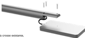
• Fixation dans le prolongement de la crosse existante, orientation du bloc optique = orientation de la crosse
