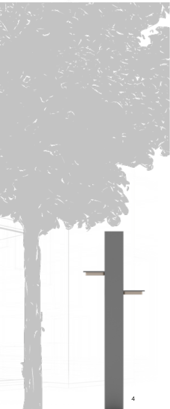
ques, hauteur 1.2 m • 4 - Louxor 2 feux décalés symétriques, hauteur 1.4 m
